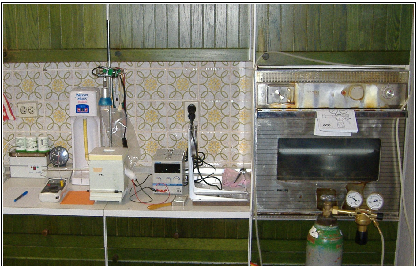
Abbildung 2: Labortreibhaus - Messplatz mit Halogenstrahler, Stromversorgung, Ventilator, CO 2 -Quelle, Argon-Druckgasflasche und Thermometern
